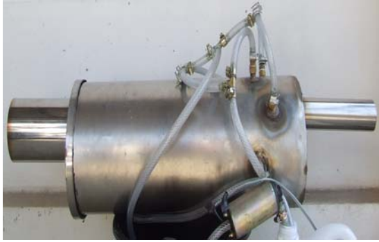
รูปที่ 2.3 หม้อพักพร้อมอุปกรณ์ฉีดพ่นละอองน้ำ
