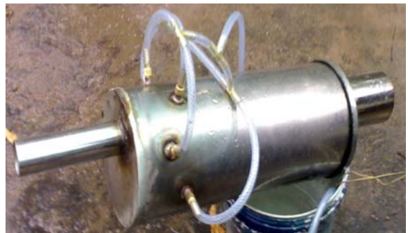
รูปที่ 3.1 รูปท่อไอเสียลดควันทำโดยละอองน้ำเมื่อประกอบเสร็จ
