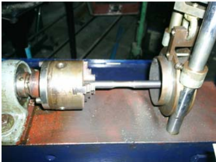
รูปที่ 3 เครื่องทดสอบความล้าแบบโมเมนต์ดัดคงที่ (Constant Bending Moment)
