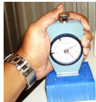
รูปที่ 5. แสดงการวัดค่าความแข็งด้วยเครื่องดูโรมิเตอร์
