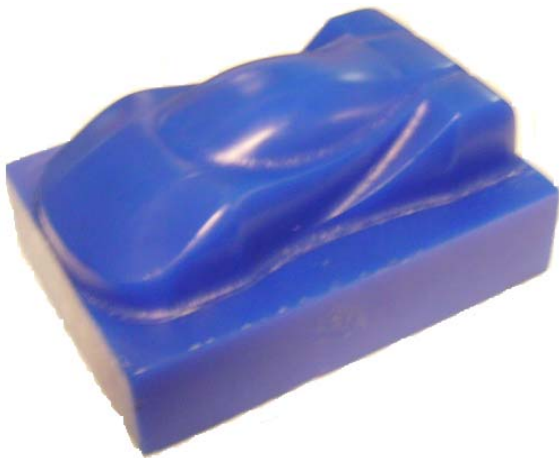
รูปที่ 14. ชิ้นงานจากแบบงานสามมิติ ที่มีผิวสำเร็จ
