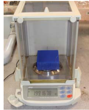
รูปที่ 7. การหามวลโดยการนำไปชั่งบนเครื่องชั่งดิจิทัล
