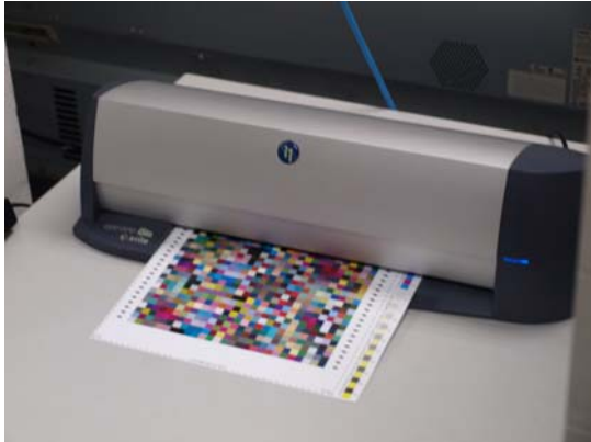
รูปที่ 6. แสดงการสแกนเก็บข้อมูลสีมาตรฐาน ECI2002 แบบอัตโนมัติด้วยเครื่อง Eye - One isis ยี่ห้อ X – Rite
