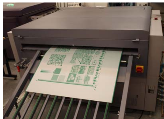
รูปที่ 1. แสดงการผลิตแม่พิมพ์ (Plate) แบบทดสอบตามมาตรฐาน ISO12647-2 ด้วยเครื่อง Computer to Plate ยี่ห้อ Kodak รุ่น Magnus 800
