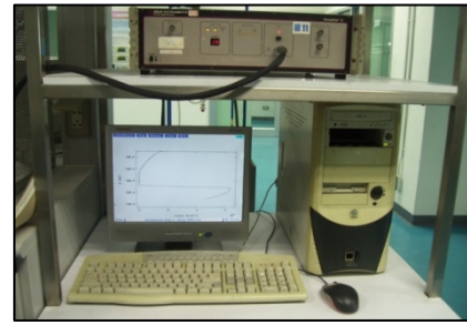
รูปที่ 3 เซลล์ทดสอบและเครื่อง Potentio / Galvanostat ที่ใช้ตรวจสอบการเกิดสภาวะ Sensitization ของเหล็กกล้าไร้สนิม
