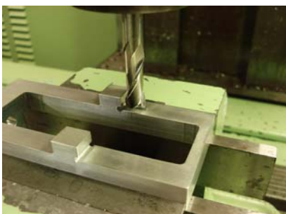
รูปที่ 6. การสร้างเครื่องมือโดยการกัดขึ้นรูปด้วยเครื่องกัด
