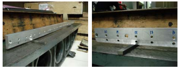
รูปที่ 17. แสดงคานบ่าสวิงวางบนแท่งขนานและอยู่บนโต๊ะระดับ
