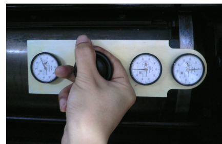
รูปที่ 16. แสดงการวัดระยะลึกป่าโมแม่พิมพ์ด้วยเครื่องมือวัดการหนุนที่สร้างขึ้น
