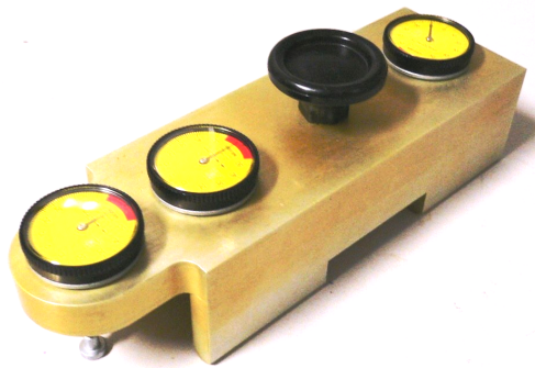
รูปที่ 12. เครื่องมือวัดการหนุน (Packing Gauge) ที่สร้างเสร็จพร้อมนำไปสอบเทียบก่อนนำไปทดสอบ
