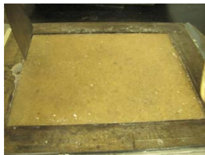
รูปที่ 3 เทอร์โมพลาสติกจากแป้งที่ผ่านการขึ้นรูปเป็นชิ้นงานรูปสี่เหลี่ยม
