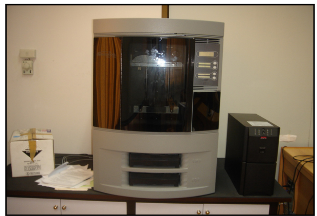
รูปที่ 11 เครื่อง RAPID PROTOTYPE ที่ใช้สร้างแม่พิมพ์พลาสติก
