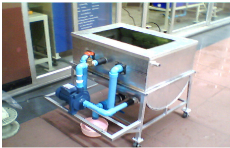
รูปที่ 1 แสดงเครื่องล้างผักและผลไม้ที่ต่อพ่วงกับเครื่องปั๊มน้ำขนาด 0.5 แรงม้า
