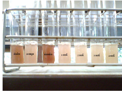
รูปที่ 18 แสดงผลการทดสอบยาฆ่าแมลงที่ ตกค้างในฝักตัวอย่างก่อนล้างและ หลังล้างด้วยเครื่องล้างฝักและผลไม้
