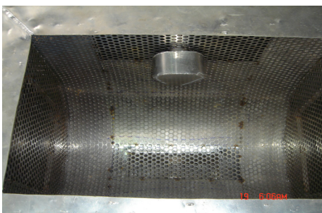
รูปที่ 2 แสดงตำแหน่งการติดตั้งหัวฉีดที่ผนังด้านในของตัวเครื่อง
