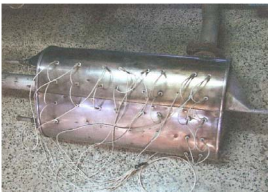
รูปที่ 3 แสดงการใส่เข็มปลายแหลมลงในหม้อกรองไอเสีย
