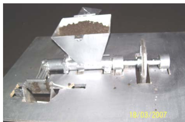
รูปที่ 6 การทดสอบเครื่องต้นแบบในการผลิตปุ๋ยอินทรีย์อัดเม็ด
