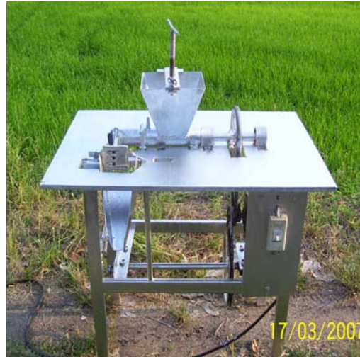
รูปที่ 5 เครื่องต้นแบบในการผลิตปุ๋ยอินทรีย์อัดเม็ด
