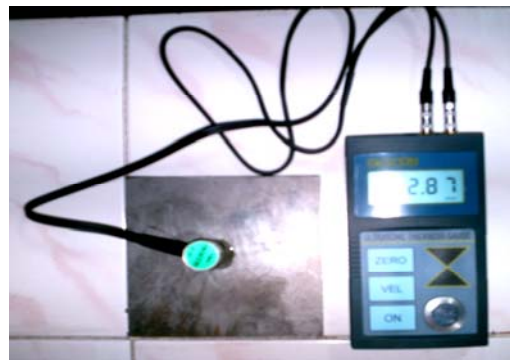
รูปที่ 6 เครื่องมือวัดความหนาของโลหะด้วยคลื่นอุลตราโซนิก (Ultrasonic Thickness Measurement)
