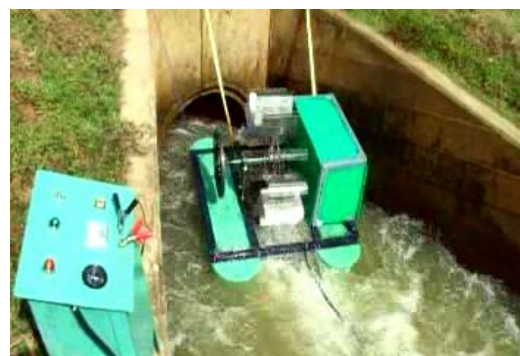
รูปที่ 5 แสดงการวางกังหันบนผิวน้ำขณะทดสอบ
