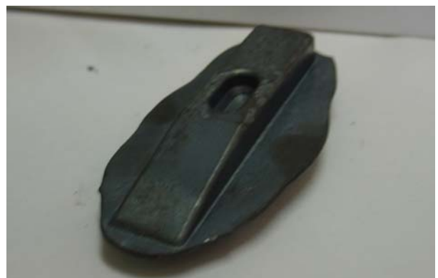
รูปที่ 8 แสดงภาพชิ้นงานภายหลังจากการตีขึ้นรูปจริง
