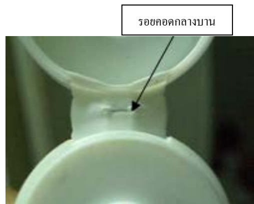
รูปที่ 1. แสดงจุดบกพร่องที่เป็นปัญหาในชิ้นงาน
