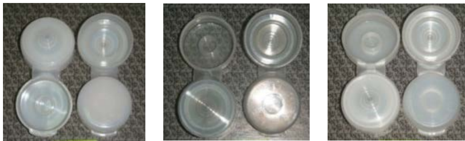
รูปที่ 6. แสดงชิ้นงานฝาพลาสติกเปิด-ปิดภาชนะที่ผ่านการขึ้นรูปด้วยกระบวนการฉีดเข้าแม่พิมพ์
