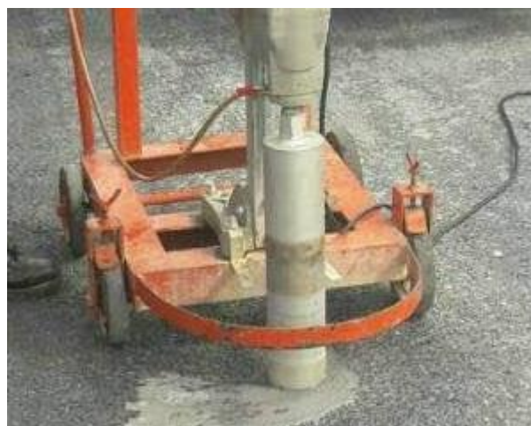
รูปที่ 2 การเจาะก้อนตัวอย่างแอสฟัลต์คอนกรีตในแปลงทดลอง
