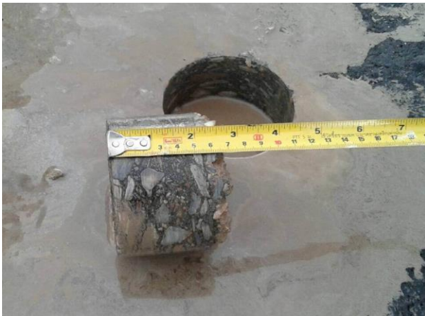
รูปที่ 3 ก้อนตัวอย่างแอสฟัลต์คอนกรีตในสนามใช้สำหรับการทดลองความหนาแน่นแอสฟัลต์คอนกรีตในสนาม
