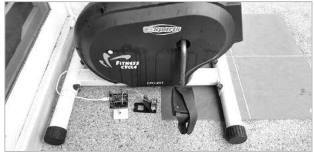
รูปที่ 12 การติดตั้งและทดสอบการคำนวณวัดระยะห่างระหว่างเซ็นเซอร์กับบันไดจักรยาน เพื่อส่งข้อมูลไปยัง Firebase Real-Time Database
