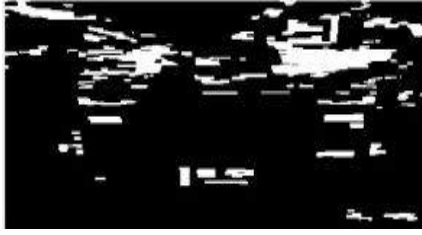
รูปที่ 6 กำจัดสิ่งรบกวนในภาพด้วยวิธีการ Opening
