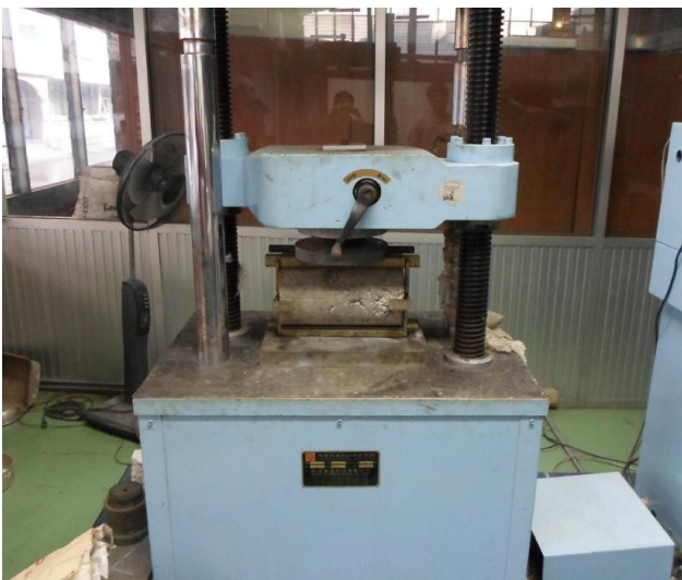
รูปที่ 6 ทดสอบกำลังรับแรงดึงของคอนกรีตผสมน้ำยาที่อัตราส่วน P/C ต่างๆ
