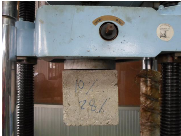
รูปที่ 10 การนำชิ้นตัวอย่างเข้าทำการทดสอบแรงยึดเหนี่ยว
