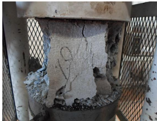
รูปที่ 4 การทดสอบกำลังอัดของคอนกรีต
