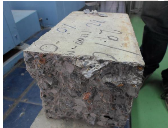
รูปที่ 8 การนำชิ้นตัวอย่างเข้าทำการทดสอบแรงดัด
