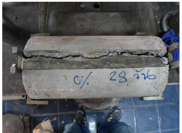
รูปที่ 6 ทดสอบกำลังรับแรงดึงของคอนกรีตผสมน้ำยาที่อัตราส่วน P/C ต่างๆ
