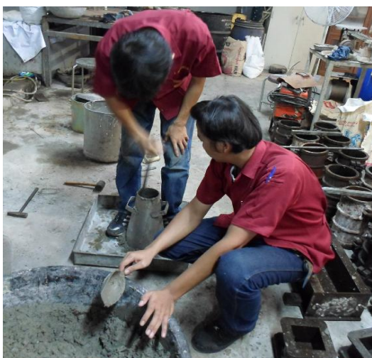
รูปที่ 2 การทดสอบความสามารถในการเทได้ของคอนกรีต
