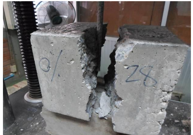
รูปที่ 10 การนำชิ้นตัวอย่างเข้าทำการทดสอบแรงยึดเหนี่ยว
