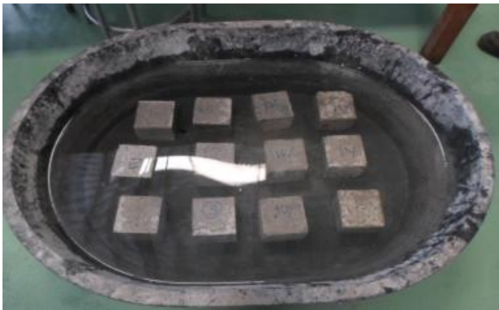
รูปที่ 12 ทดสอบการดูดซึมน้ำของคอนกรีต
