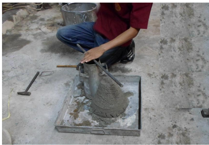
รูปที่ 2 การทดสอบความสามารถในการเทได้ของคอนกรีต
