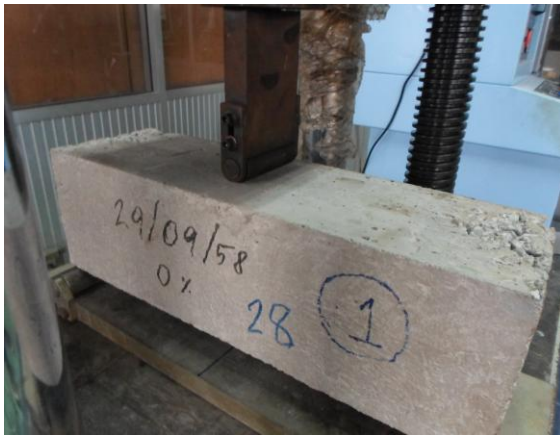
รูปที่ 8 การนำชิ้นตัวอย่างเข้าทำการทดสอบแรงดัด
