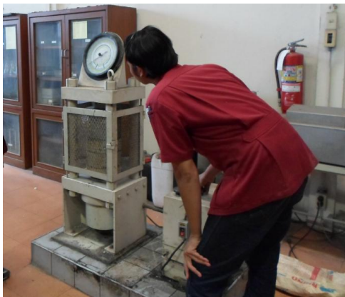
รูปที่ 4 การทดสอบกำลังอัดของคอนกรีต
