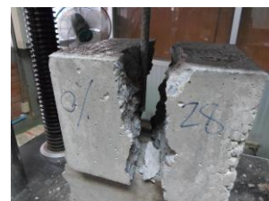
รูปที่ 6 การทดสอบแรงยึดเหนี่ยวของคอนกรีตผสมน้ำยางพาราต่อเหล็กเสริม
