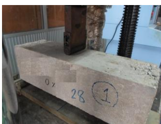
รูปที่ 5 การทดสอบกำลังรับแรงดัดของคอนกรีต
