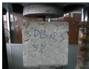
รูปที่ 6 การทดสอบแรงยึดเหนี่ยวของคอนกรีตผสมน้ำยางพาราต่อเหล็กเสริม
