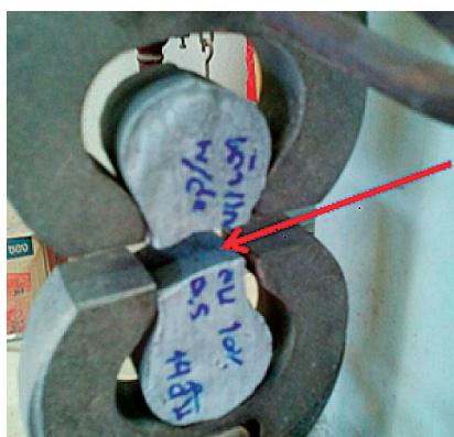
รูปที่ 3 การทดสอบกำลังรับแรงดึงมอร์ตาร์ผสมน้ำยางพารา
