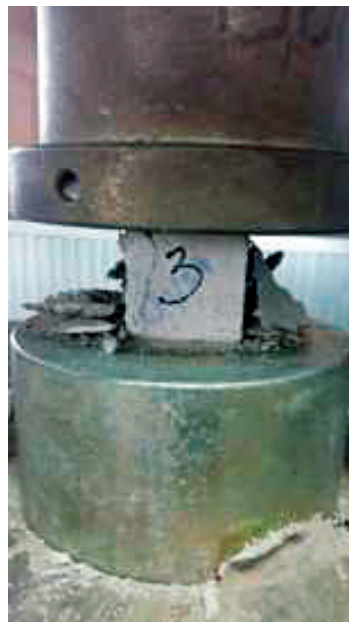
รูปที่ 2 การทดสอบกำลังรับแรงอัดมอร์ตาร์ผสมน้ำยางพารา
