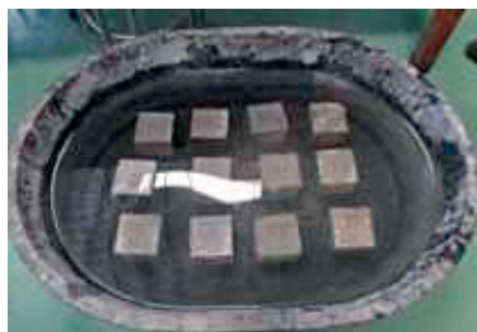
รูปที่ 5 ทดสอบการดูดซึมน้ำมอร์ตาร์ผสมน้ำยาง
