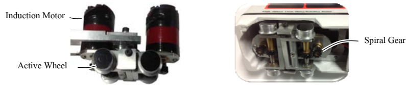
รูปที่ 5 ระบบการขับเคลื่อนของรถไฟด้วยมอเตอร์ประเภทหมุนรอบตัวเอง
