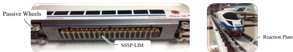
รูปที่ 6 ระบบการขับเคลื่อนของรถไฟด้วยมอเตอร์ประเภท SSSP-LIM
