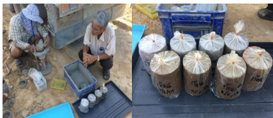
รูปที่ 4 การเก็บตัวอย่างดินซีเมนต์จากพื้นที่แปลงทดสอบเพื่อนำไปทดสอบในห้องปฏิบัติการ
